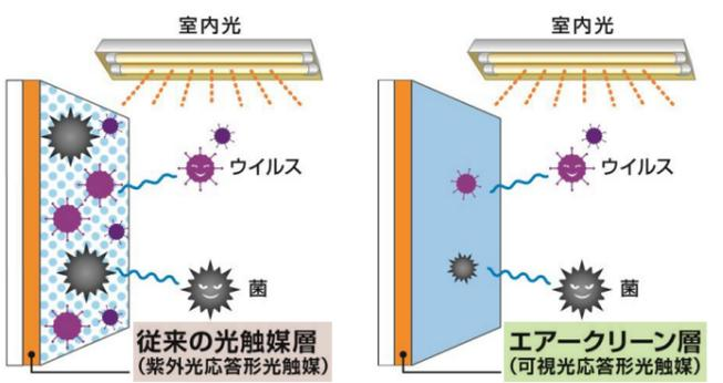
従来の光触媒 従来の光触媒(紫外光応答形)は、太陽光などの強い光の照射下で作用しますが、室内光では作用し難く、菌やウィルスの繁殖抑制効果が小さい。
